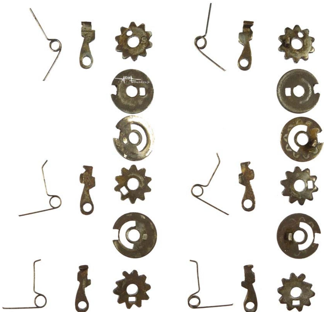
Une fois vidé, le cadenas laisse clairement voir le pêne et sa queue faisant office d'ardillon rentrant dans les roues de codage.
